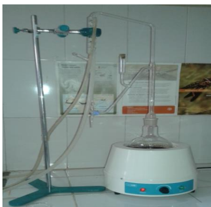
Figure 3.1: Dispositif de l'extraction des huiles essentielles par hydrodistillation.
