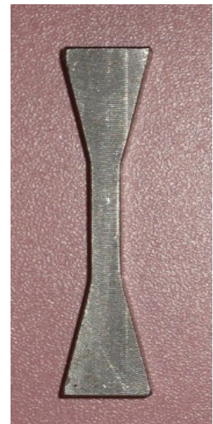
Figure 4.4 : Photo de l'éprouvette destinée aux essais de traction simple.
