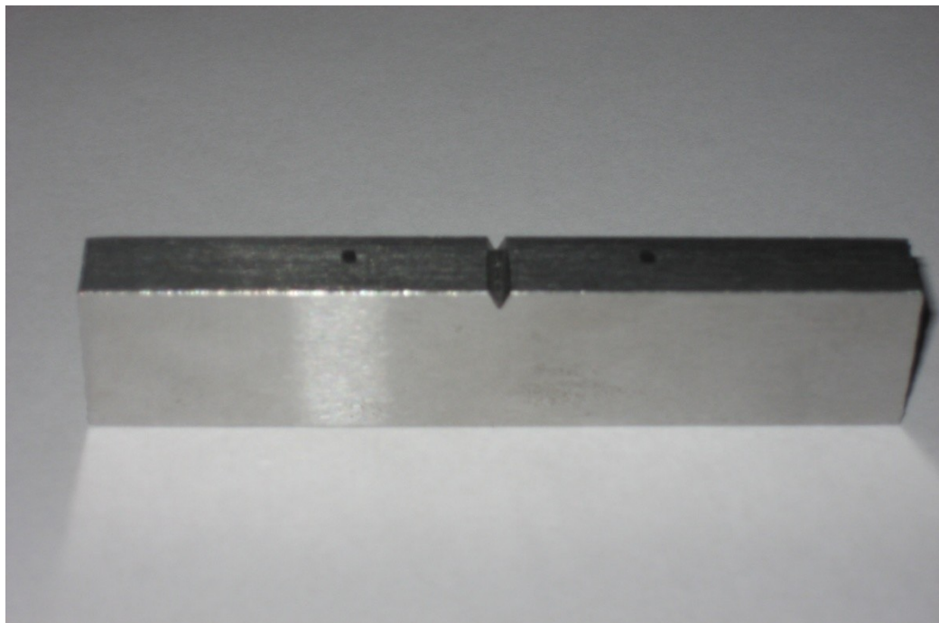
Figure 4.7 : Photographie d'une éprouvette de flexion de type SENB réalisée pour les essais
