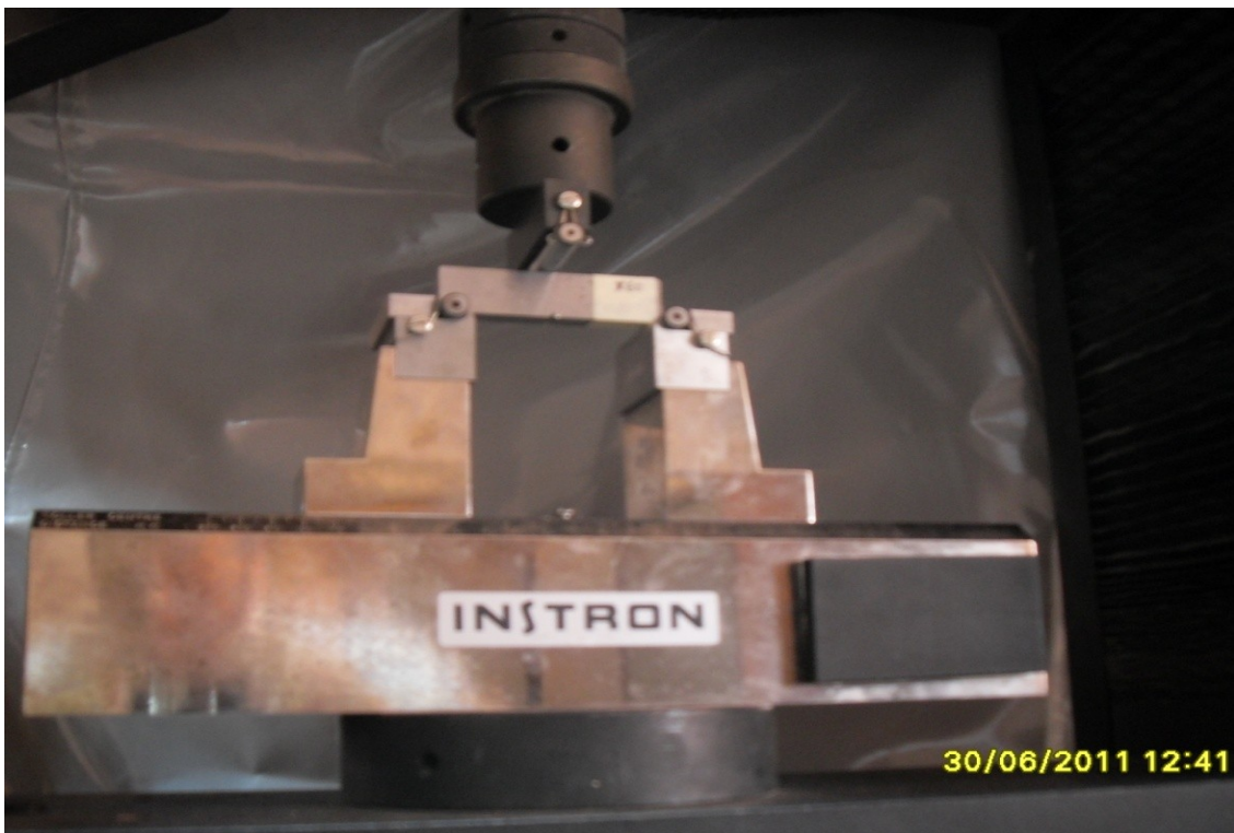
Figure 4.11b : Photo du système d'amarrage avec éprouvette.
