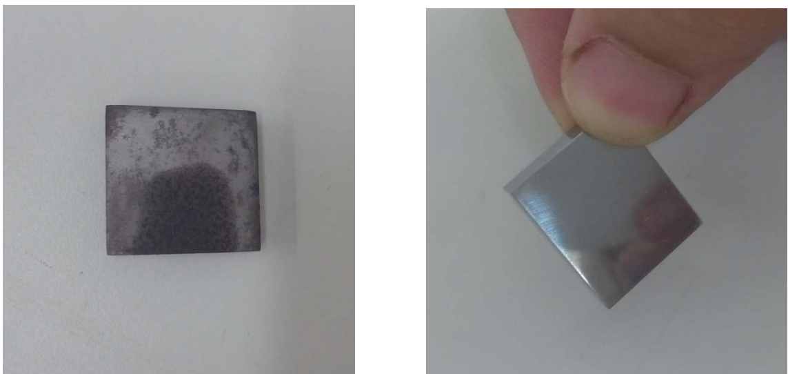
Figure 3.7 : La pièce de XC48 avant et après polissage.
