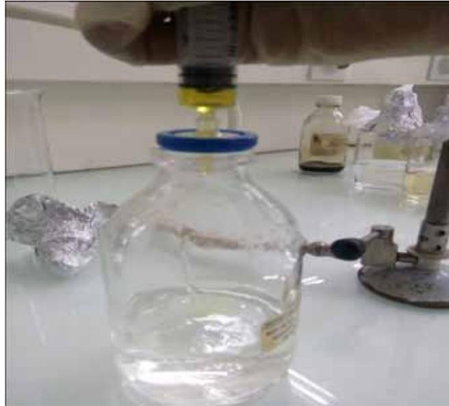
Filtration des huiles a l'aide d'un filtre 0.22 $\mu$ m
