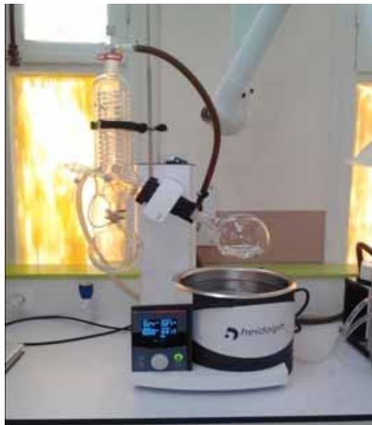
**Figure 2.4 :** Récupération de biosurfactant par le Rotavapeur
