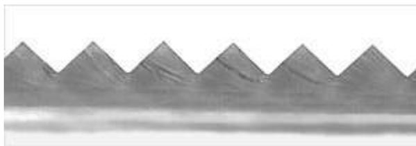
Figure 1.18 : Vue en coupe du type de film à prismes d'environ  $50\ \mu\text{m}$  sur  $30\ \mu\text{m}$  proposé par Microsharp [20].
