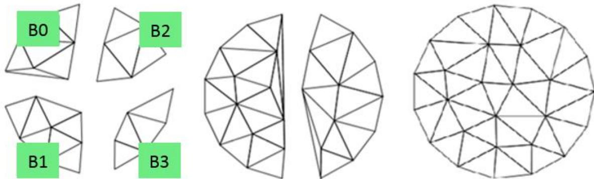
a. Triangulation de chaque bloc.    b. Fusion de B1 et B3 avec B0 et B2.    c. Fusion de B0 avec B2.
