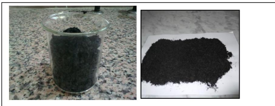
**Figure II.2 :** Tiges de dattes imprégnées au  $ZnCl_2$
