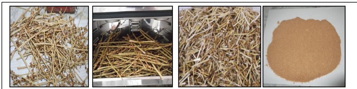
**Figure II.1** : Tiges de dattes lavées, séchées et broyées
