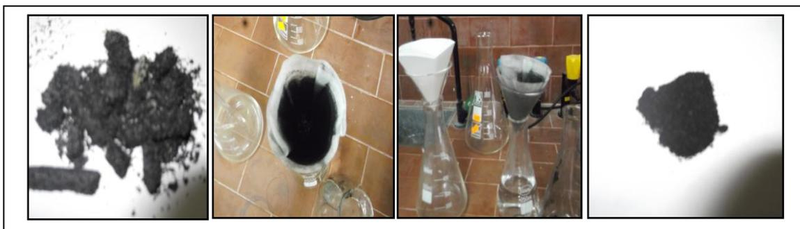
**Figure II.5 :** Opérations de lavage, séchage du charbon actif
