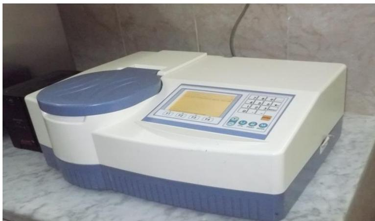
**Figure 2** : Photo spectrophotométrie UV Optizen
