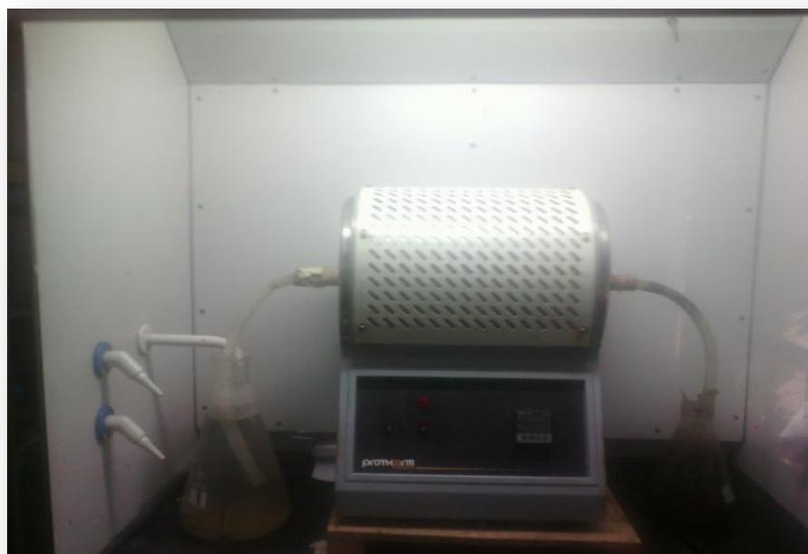
**Figure II.4 :** Dispositif de carbonisation
