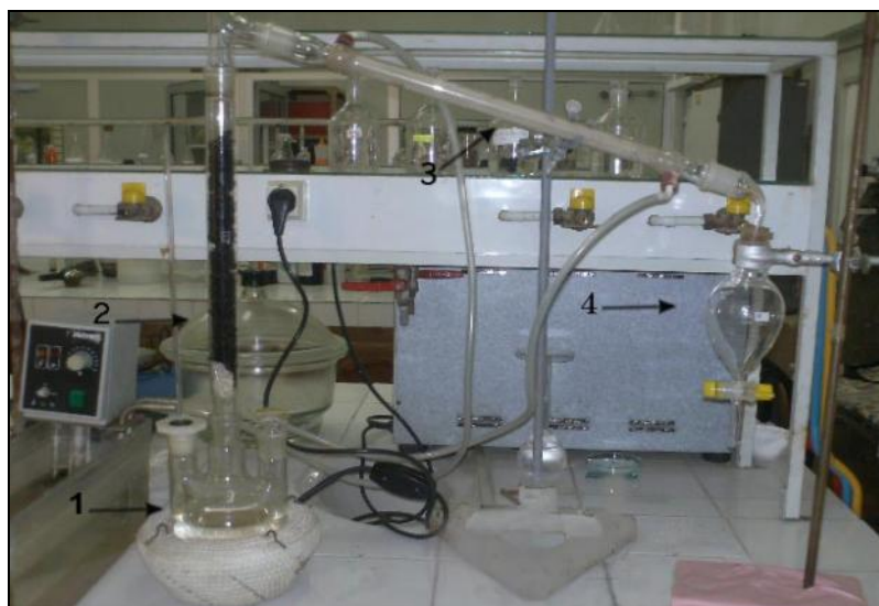
Figure 4.1 : Entraînement à la vapeur d'eau
