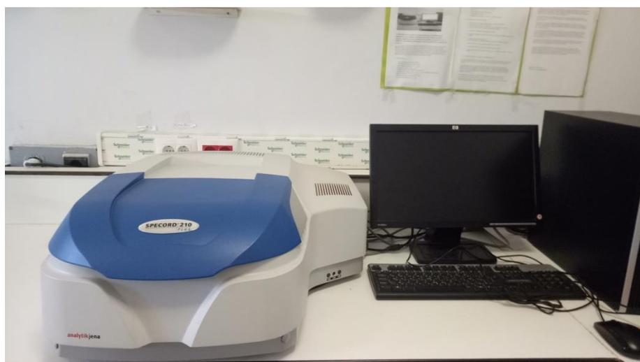
**Figure III.13 : Spectrophotomètre UV-Visible**
