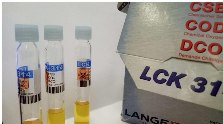
Figure III.5 : Tubes commerciaux étalon de DCO
