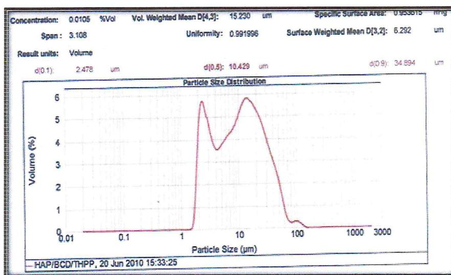
**Fig. III.12:** *Diagramme granulométrie laser des microparticules d'HAP.β-CD : THPP/SBF*
