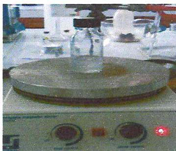
Fig. IV.1 : Synthèse des Nps du CS par la méthode de la gélotion
