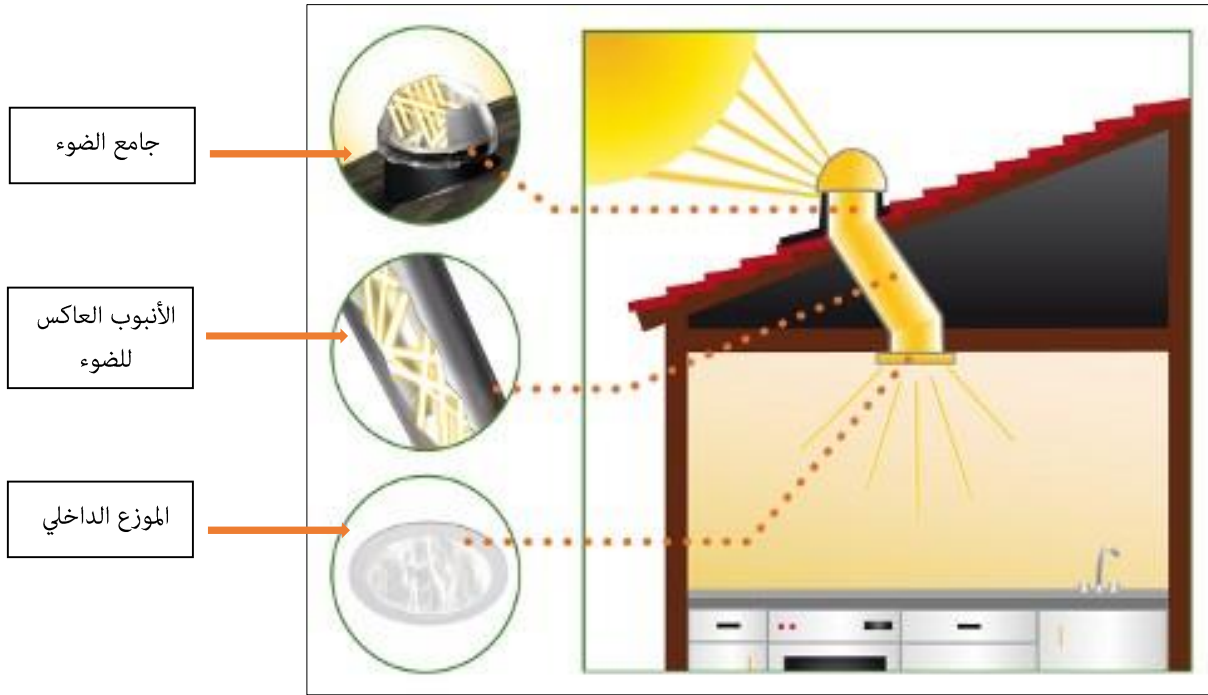
الشكل 19.1: عناصر الأنبوب الضوئي /المصدر: Blogecolo 2
