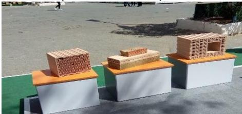
Figure 110 : Brique thermoplane
