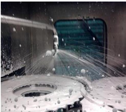
**Figure 5** : nettoyage manuel (canon à mousse)
