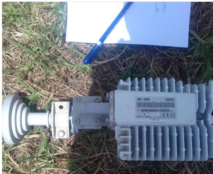
Figure IV.3 : BUC et LNB choisi pour la transmission
