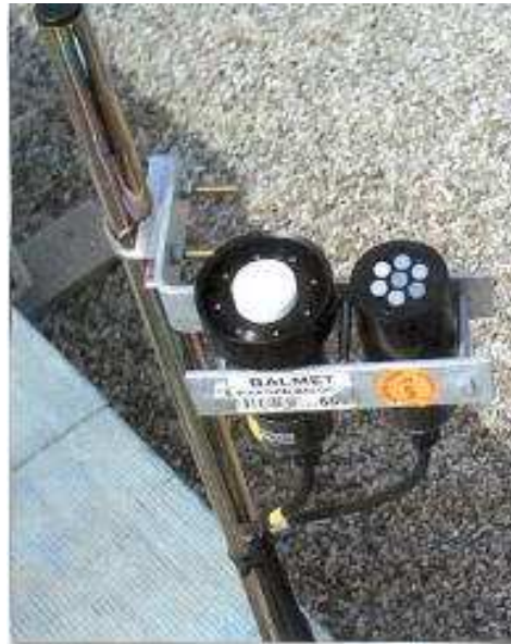
Figure 1.7: radiomètre SAAtlantic OCR-504I de surface.
