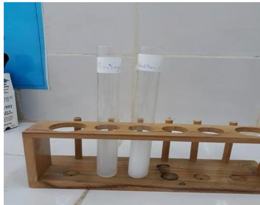
Figure 3.8. : Résultat du test de sulfates par comparaison de la solution témoin et l'échantillon de l'hôpital Mustapha.
