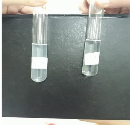
Figure 3.6. : Résultat du test chlorure sur l'eau traitée du Chu Mustapha.
