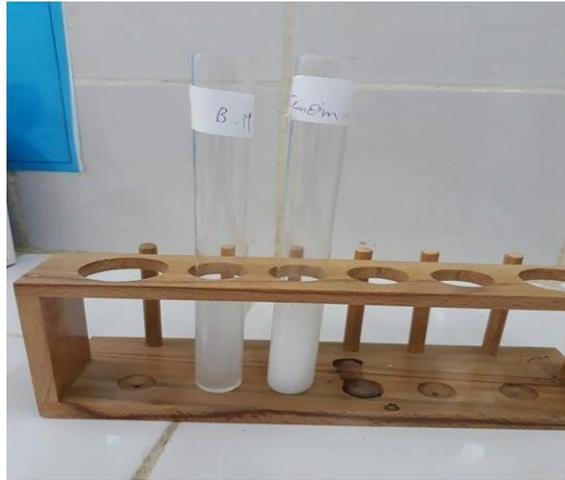
Figure 3.7. : Résultat du test de Sulfates par comparaison de l'eau traitée de l'hôpital Beni Messouss et la solution témoin.
