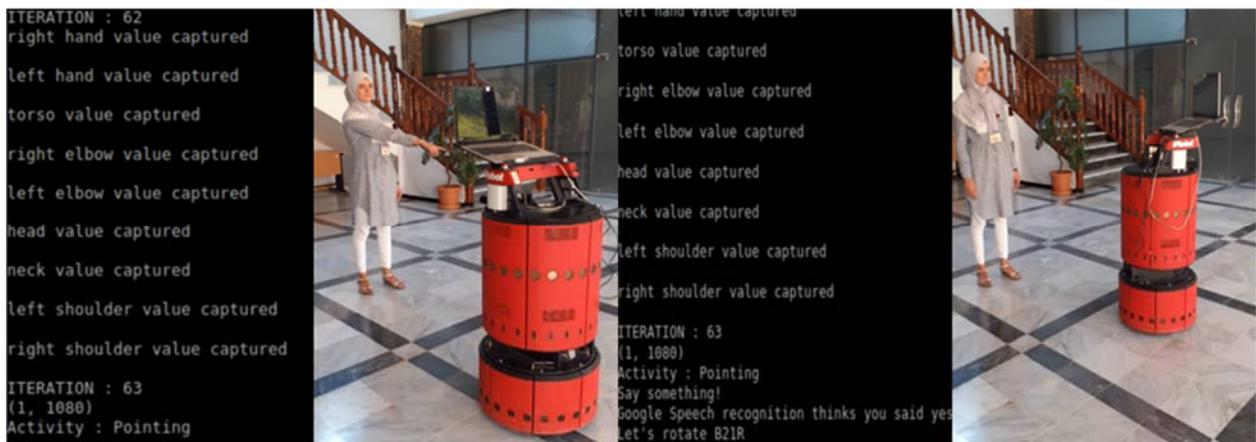
**Figure 46 : Test en temps réel de la reconnaissance de l'activité « Pointer » en utilisant le robot .**
