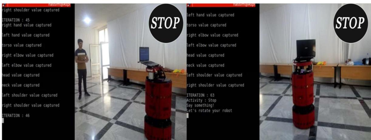
**Figure 48 : Test en temps réel de la reconnaissance de l'activité « Arrêter » en utilisant le robot .**
