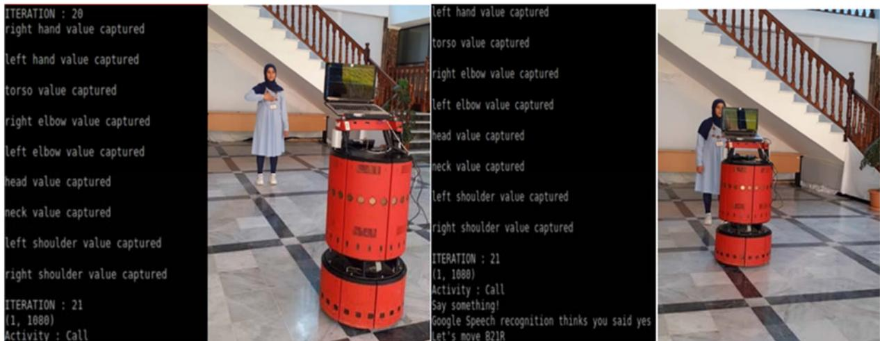
**Figure 45 : Test en temps réel de la reconnaissance de l'activité « Appeler » en utilisant le robot.**
