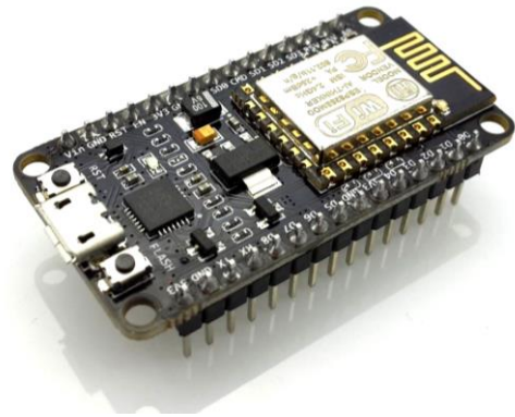
Figure III.4 : Module ESP8266 sur NodeMCU
