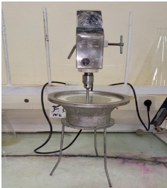
Figure III.3 montage d'un granulateur a voie humide
