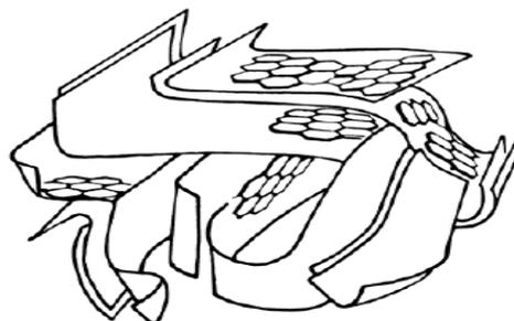
**Figure 1.15 :** Représentation de la microstructure d'un charbon actif.
