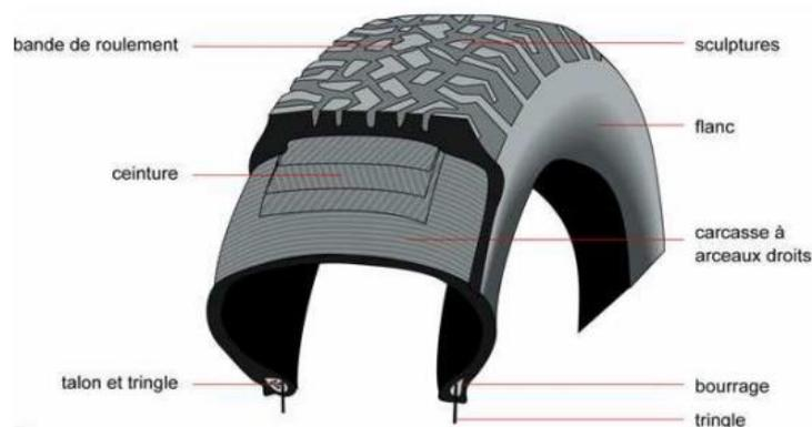
**Figure.1.16** : Coupe transversale d’un pneu Michelin [87]
