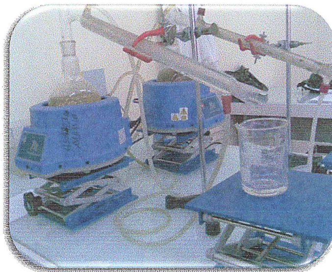
Figure II.1: Montage d'hydrodistillation utilisé pour la préparation de l'HE de carvi
