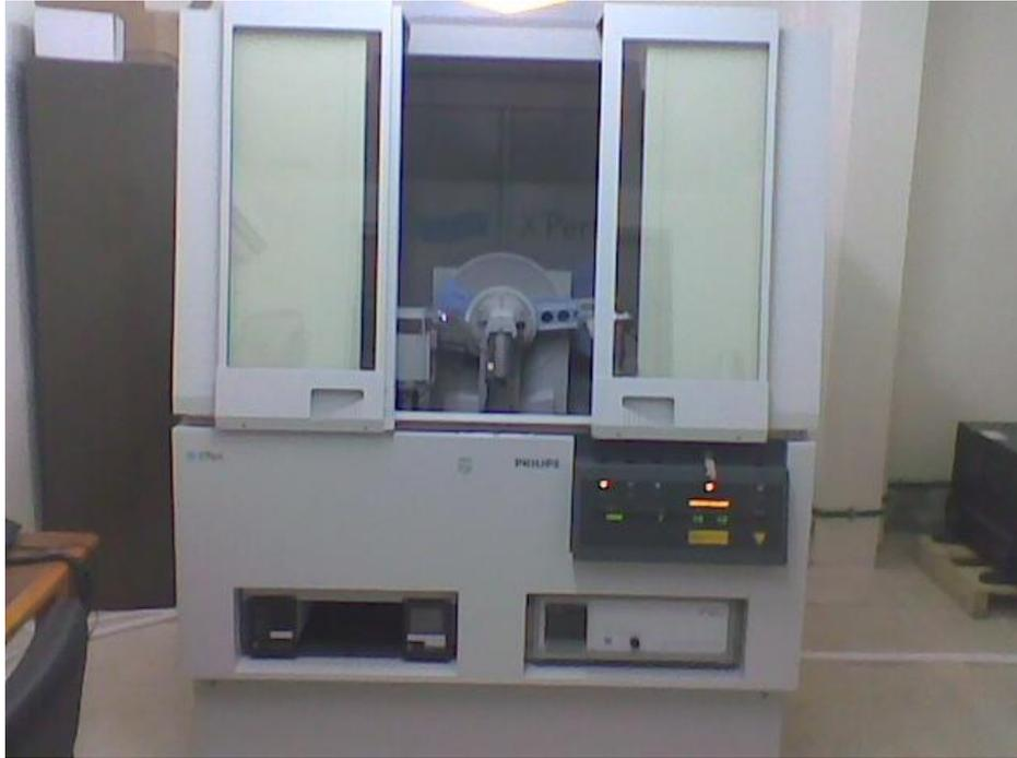
Figure 4.1 : Diffractomètre X'Pert Pro MPD
