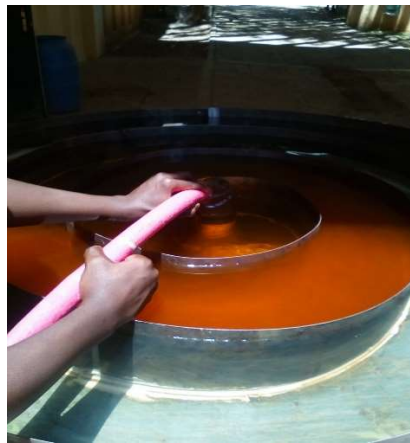
Figure 4- 9 Injection impulsion au centre de réacteur alimenté par une débit fixe choisie
