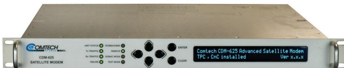
FigureII.15 : Le modem satellite avancé CDM-625
