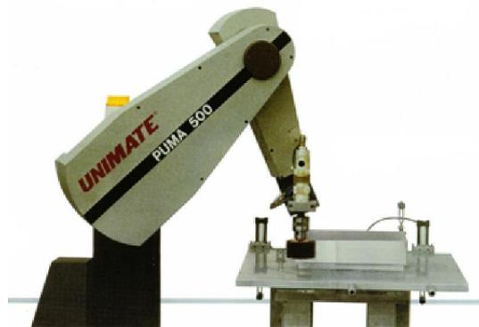
Figure 1.2 : Robot PUMA a 6 degrés de libertés
