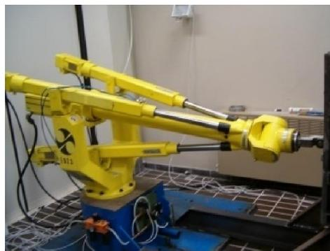
Figure 1.5 : un robot GMF à six degrés de liberté
