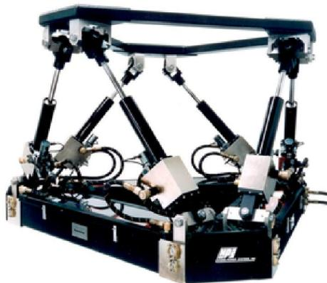
Figure 1.4 : plateforme de Gough-Stewart à 6 degrés de libertés
