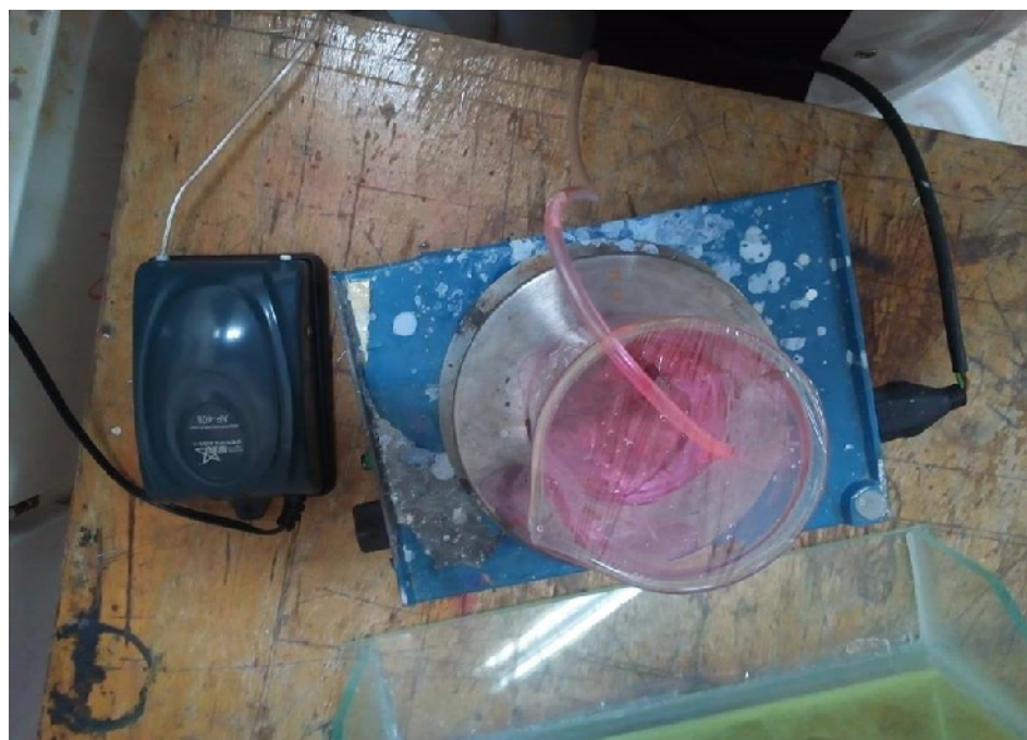
Figure II.9 : Pompe à injection d'air ( O_2 ).
