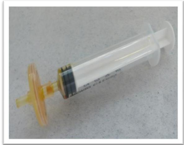
**Figure 60 :** Système de filtration par un disque contenant un papier Watman
