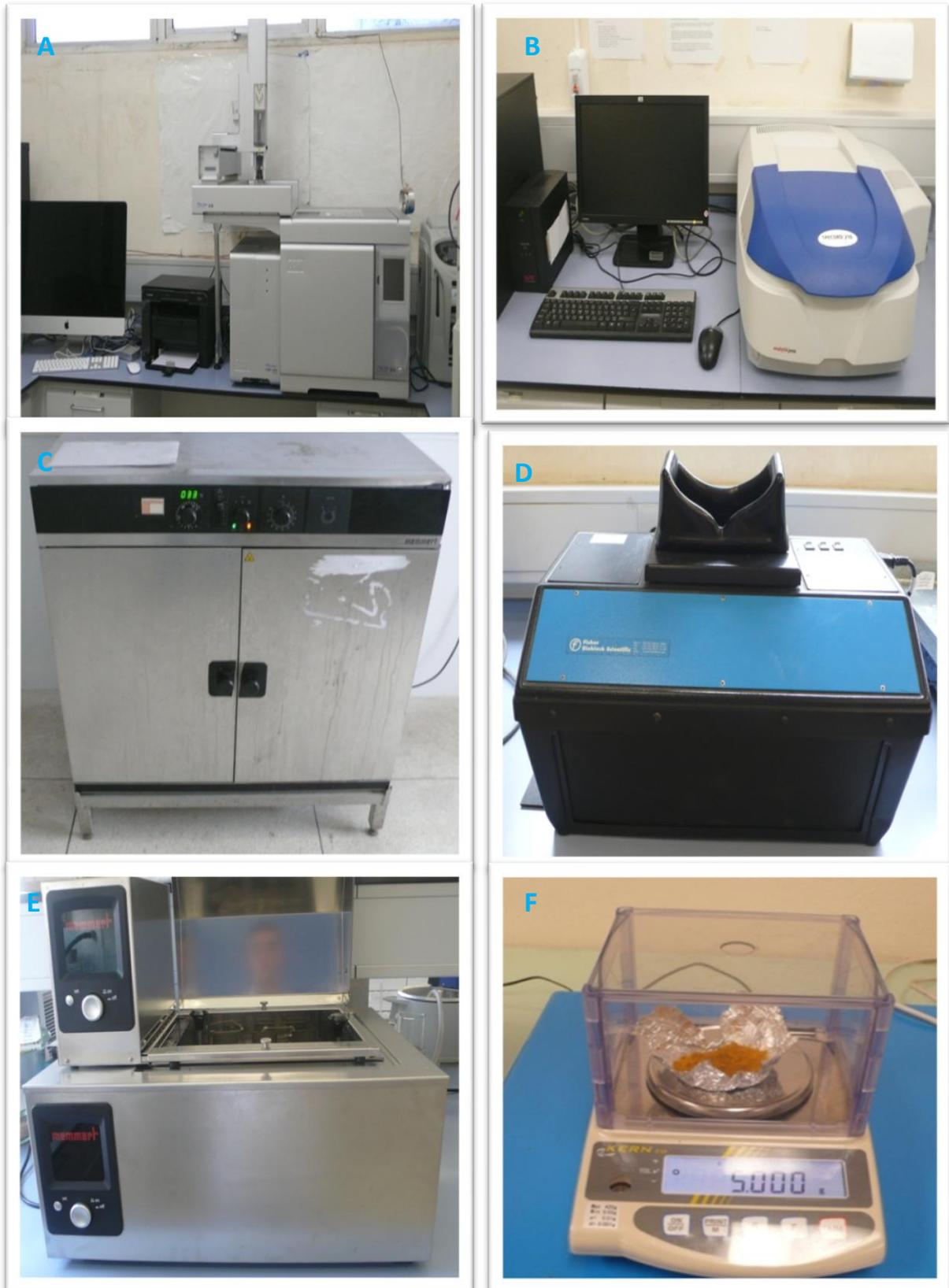
**Figure 56** : Matériel de laboratoire utilisé. A : GC-MS, B : Spectrophotomètre uv-visible, C : Etuve, D : révélateur uv, E : Bain marie, F : Microbalance.
