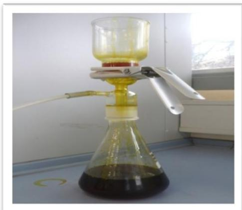
**Figure 14:** Système de filtration sous vide
