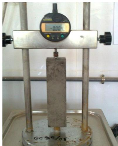
Figure 3.11: Dispositif pour l'essai de retrait
