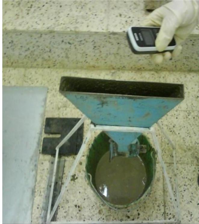
Figure 3.9: Essai à l'entonnoir en V pour mortier.
