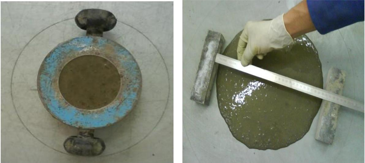
Figure 3.8: Essai d'étalement pour mortier.
