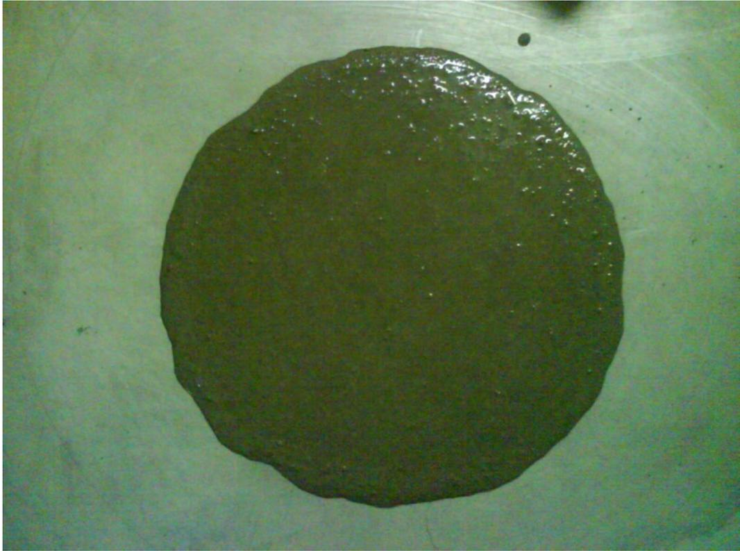
Figure 4.4 : Aspect du mortier autoplaçant à base de pouzzolane.
