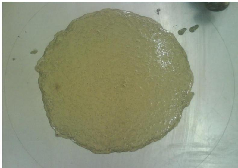
Figure 4.7: Aspect du mortier autoplaçant à base de laitier.
