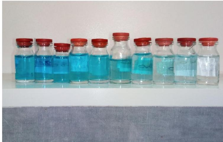
**Figure.2.1.** Décoloration temporelle du colorant au cours de la photodégradation.
