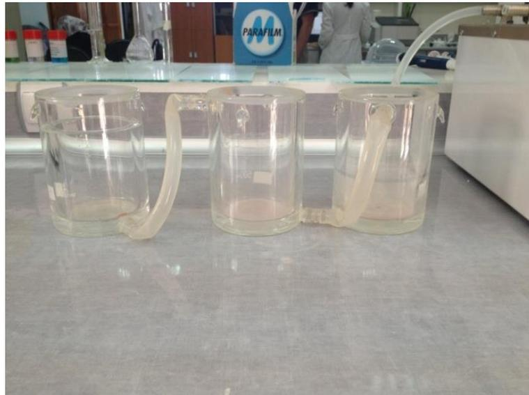
**Figure.1.4.** Photo-réacteur en batch
