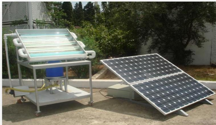
**Figure. 1.2.** Photo-réacteur tubulaire alimenté par des panneaux photovoltaïques
