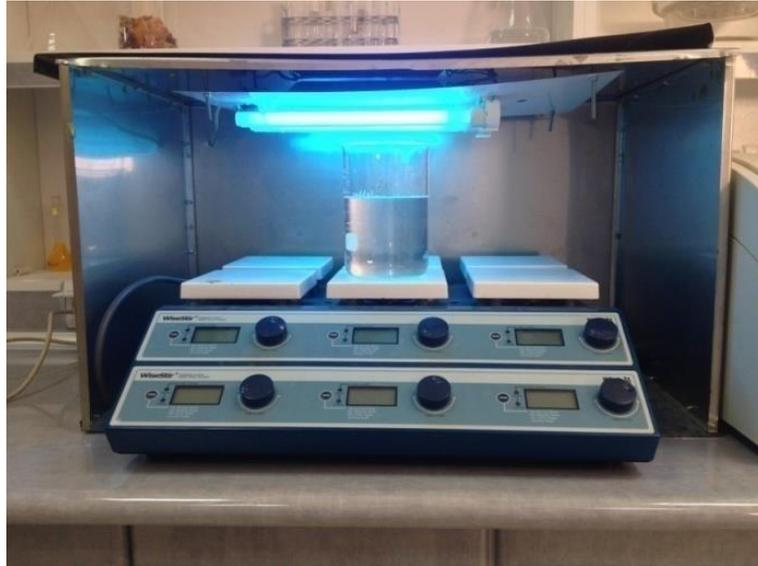
**Figure.1.5.** Photocatalyse par des lampes U.V.
