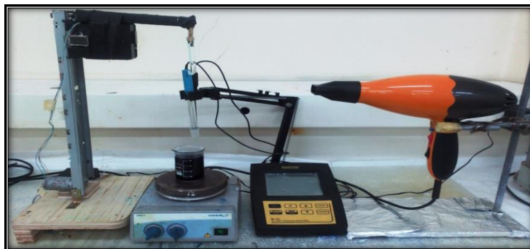
Figure 2.4. Préparation des couches minces par la technique trempage-tirage
