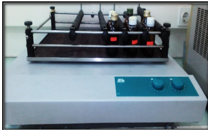
Figure 2.3. Photo de la table d'oscillation utilisée.
