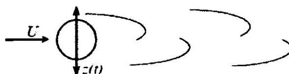
Figure 1.5. Cylindre excité par détachement tourbillonnaire.
