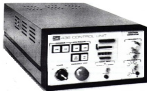
Figure 1.10 : Exemple d'unité de contrôle du système hydraulique modèle MTS 436
