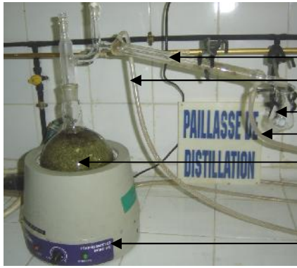
C5 : Hydrodistillation à l'échelle de laboratoire (Original, 2009).
