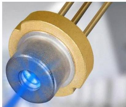
Figure 2. 2: Une diode laser.
