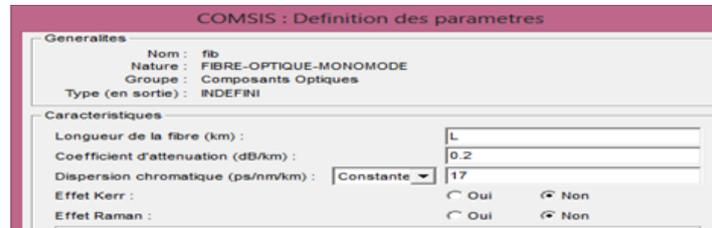
Figure 3. 19: Paramètres caractéristiques de la fibre optique.
