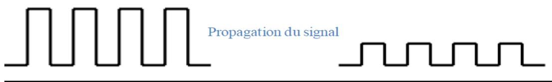
Figure 2. 14: L'atténuation dans la fibre optique.
