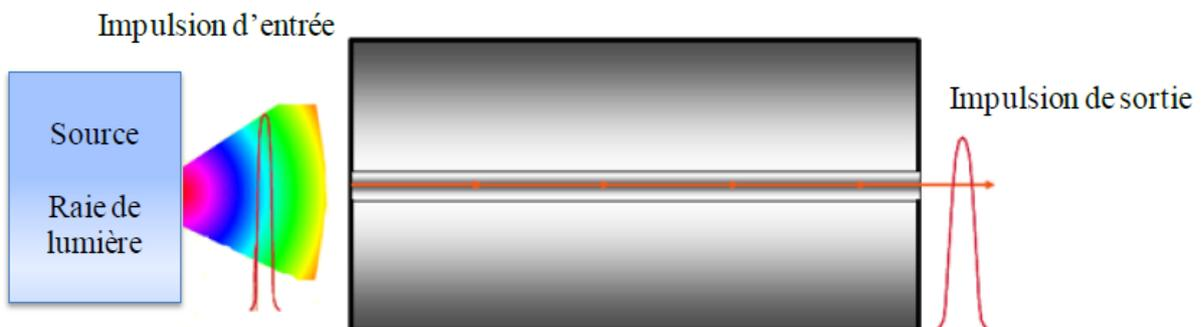
Figure 2. 13: Fibre optique monomode.
