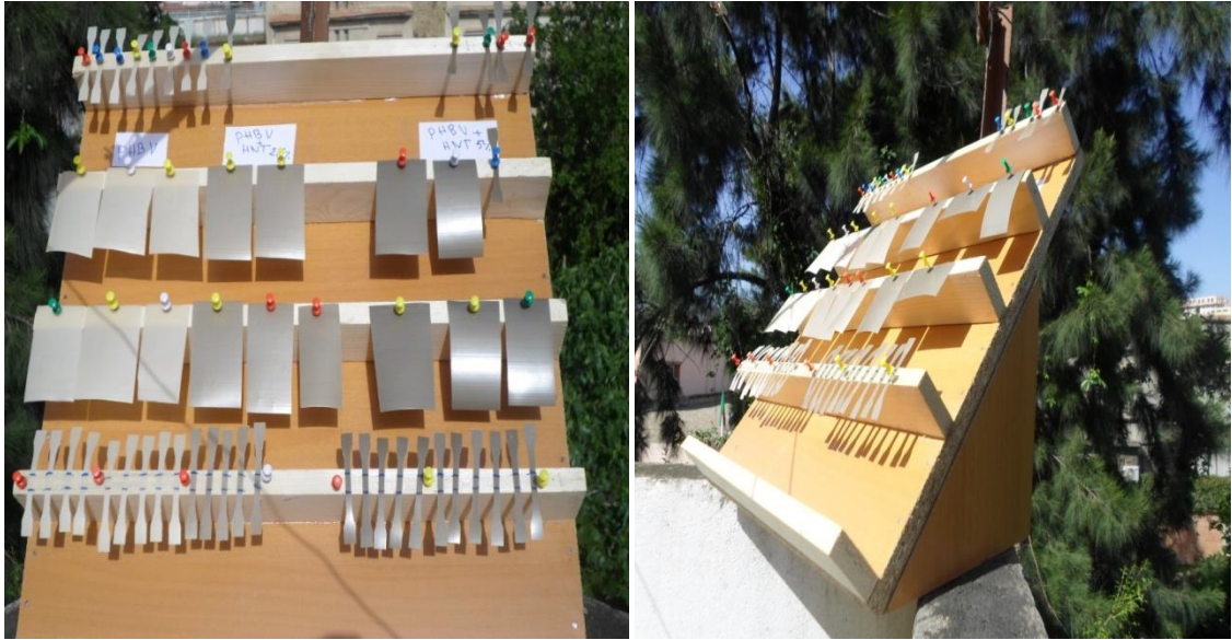
Figure 2.4 : Dispositif d'exposition en vieillissement naturel.
