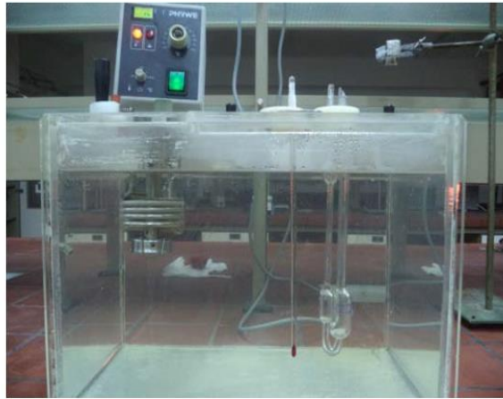
Figure 2.9: Montage utilisé pour la détermination de la viscosité.
