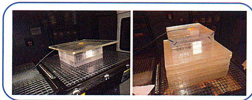
p. 102 - Figure 45 : Mise en place des plaques de plexiglas pour la correction de la dose en sortie du faisceau en présence d'une cavité à faible densité.
