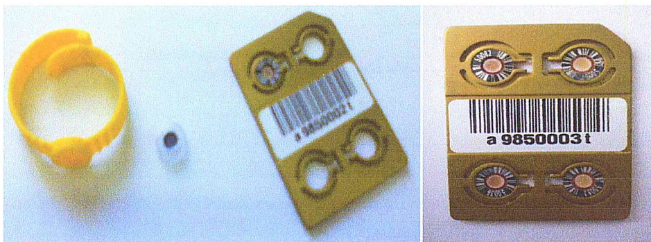
Figure. IV.13: Le dosimètre bague DXT-RAD et le support utilisé pour la lecture des détecteurs
