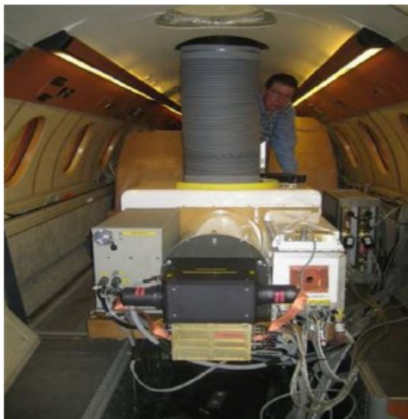
Figure 1.4 : LEANDRE 2 à bord FALCON 20
