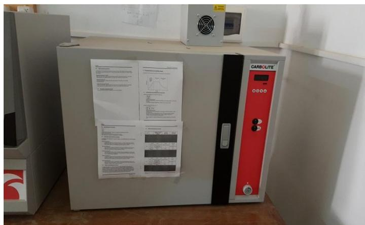
Figure. II-7 : Étuve de type CARBOLITE PF 60
