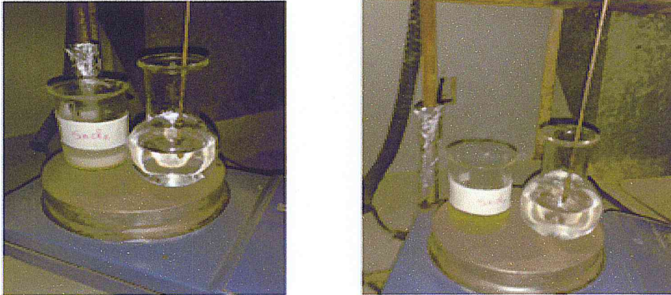
Fig.3.5: solutions des réactions chimiques de dépôts de SnO 2
