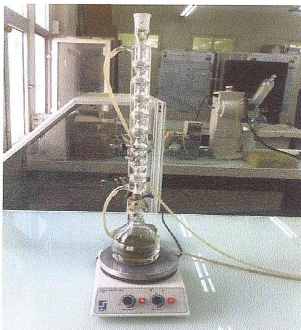
**Figure 9 : montage à reflux**
