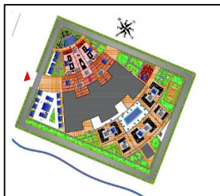
Figure 79 l'Emplacement des PV sur les testerasse et la pergola (Source : auteur)
