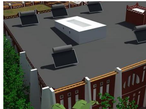
Figure 80 Emplacement des capteurs CES dans la terrasse de l'hôtel (Source: auteur)
