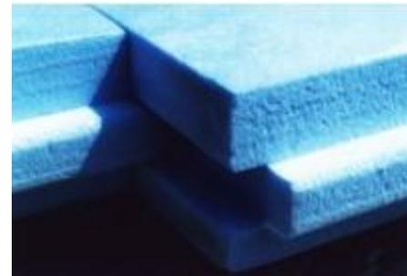
**Fig. II-8.** Polystyrène extrudé en panneau. (Source : C. Langlais & al.)
