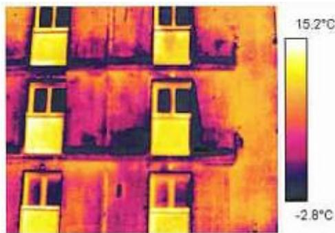
**Fig II-27** .Thermographie pour déceler les points faibles de l'enveloppe. On remarque en couleur foncée les ponts thermiques dus à la jonction avec les balcons
