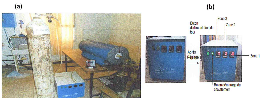
Fig.2.10 : Vue (a) du dispositif expérimental avec les raccords aux sources de gaz et (a) le régulateur de la température (b)
