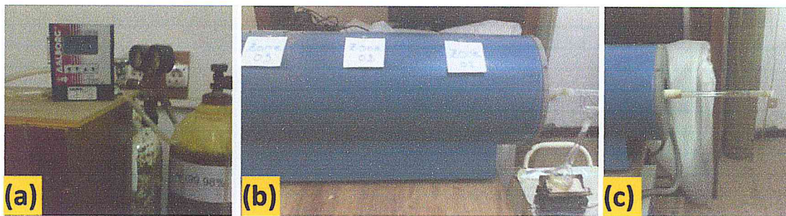
Figure II.8 : différents composants de la technique APCVD, (a) débitmètre (b) four tubulaire (c) tube en quartz
