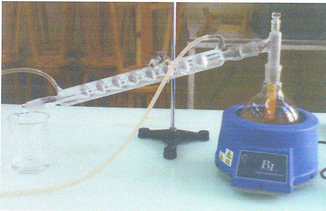
**Figure II.4** Montage de l'entraînement à la vapeur de l'extrait.
