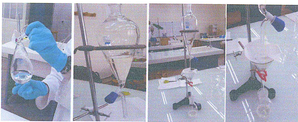
Figure 3.2: extraction liquide/liquide de l'huile essentielle de Cystoseira tamariscifolia et séchage sur du sulfate de magnésium
