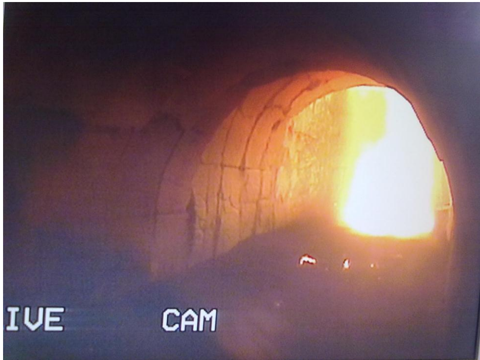
Figure 6.2 : Aspect du clinker à l'entrée du refroidisseur prise par caméra
