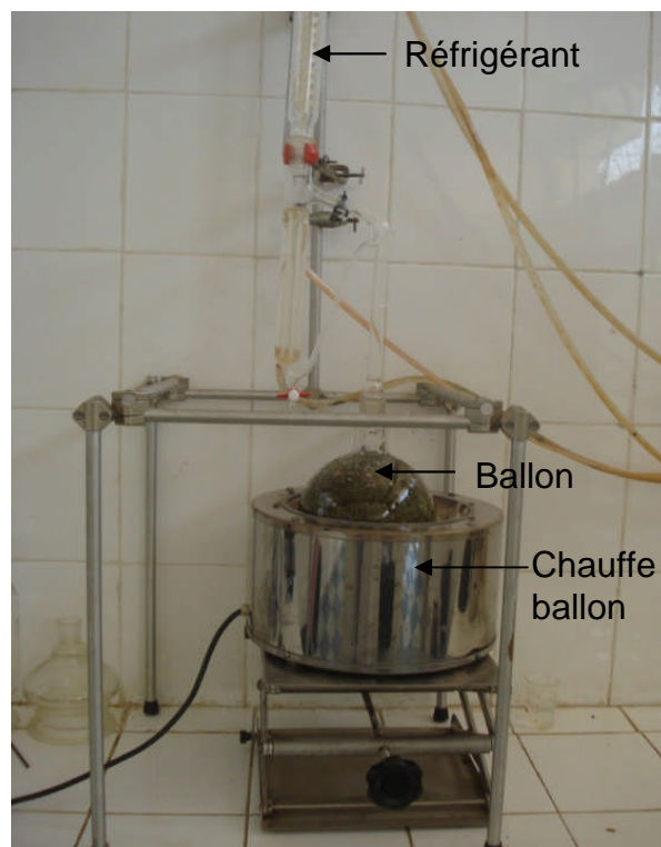
Figure 2.1 : Montage du dispositif de Clevenger (Originale 2010).
