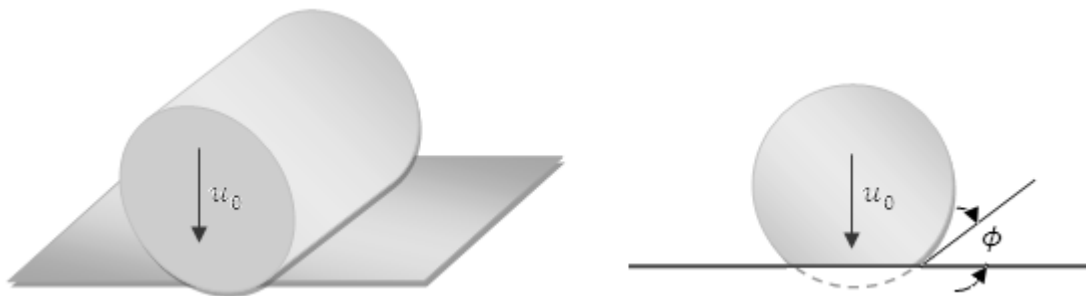
Figure 2.6: L'impact d'une surface incurvée sur une cible plane.
