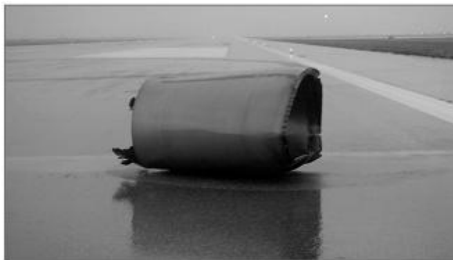
Figure 1.8: La partie externe de la tuyère d'éjection à 300 m du seuil de la piste 22L.
